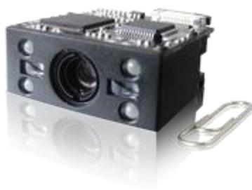
功耗的优秀标杆。独特的完全一体化设计，在极小的尺寸内完全集成图像采集、照明瞄准和解码器，既小又轻，性能强劲。非常适合嵌入各种行业的产品中使用，如数据采集器、抄表设备、检票机、自助设备等。
